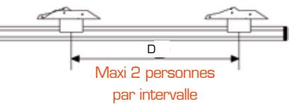
D = 4 mètres pour une utilisation du rail uniquement en système antichute
